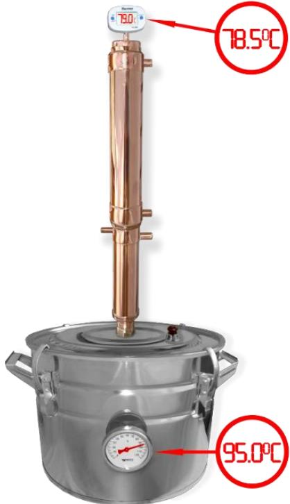
По окончании отбора грави, водоток через дефлегматор, следует ещё более ограничить для увеличения отбора и предотвращения захлёба колонны, обязательно контролируя температуру паров после дефлегматора. Она не должна превышать **80°C**, лучше **78-79°C**. Температура воды на выходе из дефлегматора должна составлять от **55°C** до **68°C**, в идеале - **62°C**. Это этап отбора тела.
